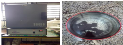
Gambar 2 .Perlakuan panas hardening dengan media pendingin air
