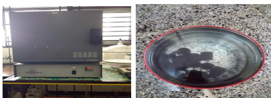
Gambar 2 .Perlakuan panas hardening dengan media pendingin air
