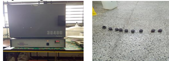
Gambar 3. Perlakuan panas Normalising dengan media pendingin udara
