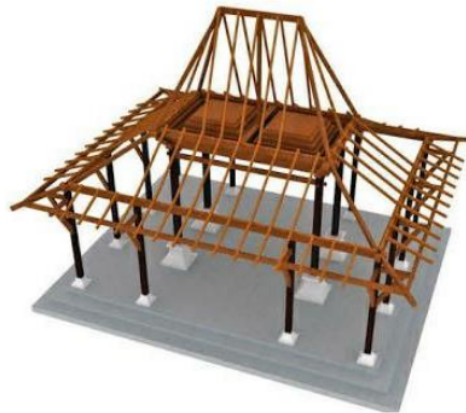
Gambar 3. Rangka Atap Rumah Joglo Sumber Gambar: Hakim (2017)
