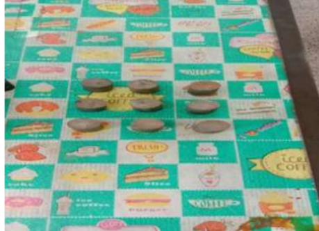
(Gambar A Hasil rendaman spesimen tanpa perlakuan panas dan media pendingin dengan media korosi air laut, air sungai dan H 2 SO 4 )
