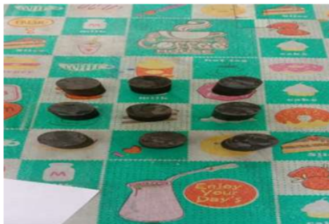
(Gambar D Hasil rendaman spesimen perlakuan panas dan media pendingin air dengan media korosi air laut, air sungai dan H 2 SO 4 )
