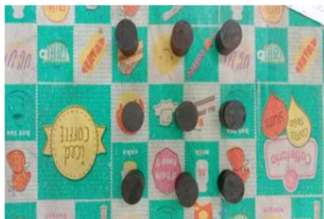
(Gambar B Hasil rendaman spesimen perlakuan panas dan media pendingin oli)
