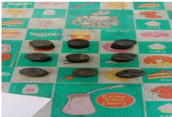
(Gambar D Hasil rendaman spesimen perlakuan panas dan media pendingin air dengan media korosi air laut, air sungai dan H<sub>2</sub>SO<sub>4</sub>)
