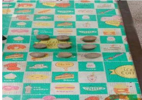
**(Gambar A Hasil rendaman spesimen tanpa perlakuan panas dan media pendingin dengan media korosi air laut, air sungai dan  $\text{H}_2\text{SO}_4$ )**
