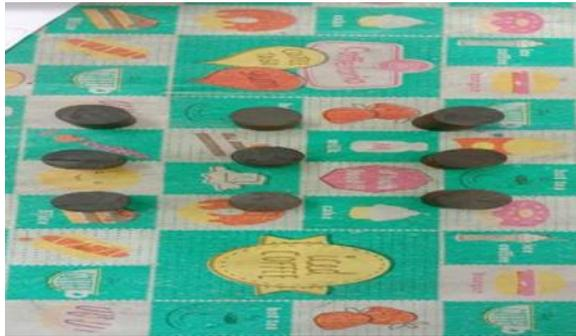
(Gambar C Hasil rendaman spesimen perlakuan panas dan media pendingin minyak bimoli dengan media korosi air laut, air sungai dan H<sub>2</sub>SO<sub>4</sub>)
