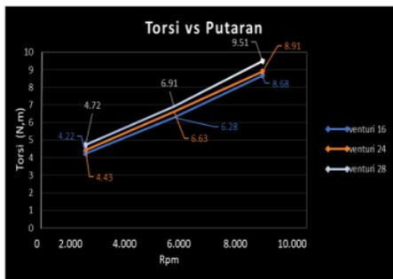
Dari grafik di atas, diperhatikan bahwa jumlah torsi yang tinggi dibagian venturi 28 mm dengan putaran mesin 8.000 rpm dengan nilai 9,51 N.m
