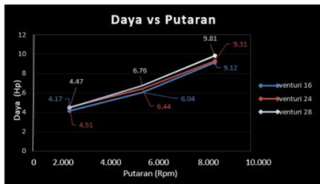
Dari grafik di atas, bisa dilihat bahwa nilai daya paling tinggi terletak pada venturi 28 mm dan putaran mesin 8.000 rpm dengan nilai 9,81 Hp. Dan nilai daya terendah pada venturi 16 mm dengan putaran mesin 4.000 rpm dengan nilai 4,17 Hp.
