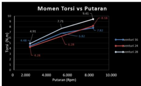
Dari grafik di atas, diperhatikan bahwa nilai Momen Torsi tertinggi terletak pada venturi 28 mm dengan putaran mesin 8.000 rpm dengan nilai 9,41 N.m
