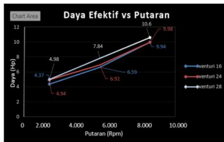
Dari grafik di atas, diperhatikan bahwa nilai Daya Efektif tertinggi letaknya di venturi 28 mm dengan putaran mesin 8.000 rpm dengan nilai 10,6 Hp.
