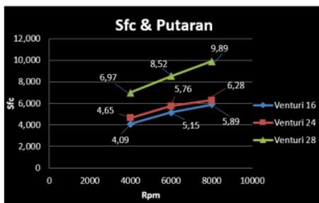
Dari grafik di samping, diperhatikan bahwa nilai konsumsi bahan bakar sfc tercepat terletak pada venturi 28 mm dengan putaran mesin 8.000 rpm dengan nilai 9,86 gr/kw.
