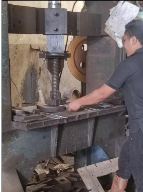
Lampiran 2 proses pemotongan spesimen sebelum di las
