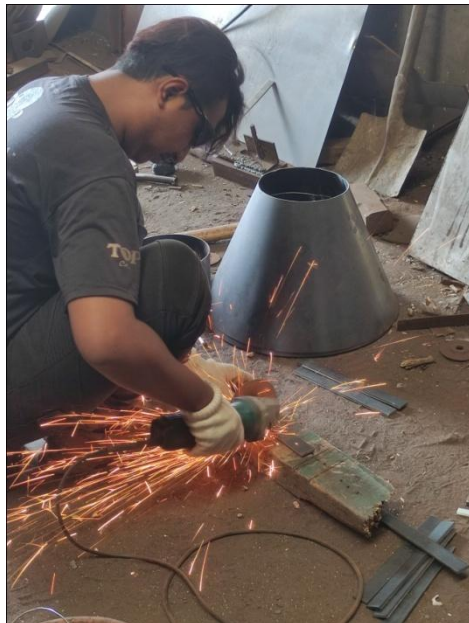
Lampiran 2 proses pemotongan spesimen sebelum di las
