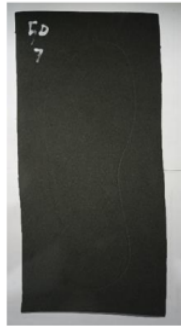
Gambar hasil pengujian pada pneumatik 50 dengan tekanan 7 bar
