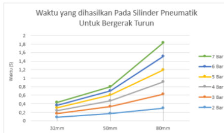
Gambar hasil pengujian pada pneumatik 80 dengan tekanan 7 bar
