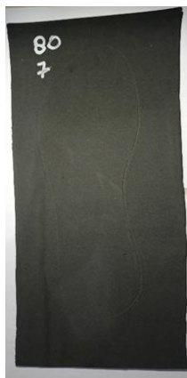
Gambar hasil pengujian pada pneumatik 80 dengan tekanan 7 bar
