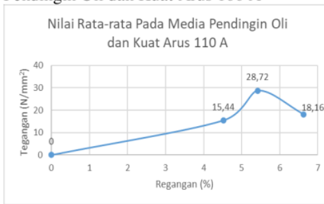
Gambar 16. Grafik Tegangan Pada Media Pendingin Oli dan Kuat Arus 110 A
