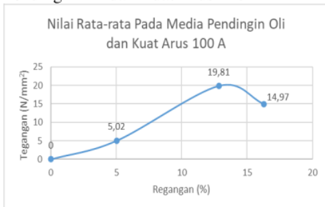
Gambar 15. Grafik Tegangan Pada Media Pendingin Oli dan Kuat Arus 100 A
