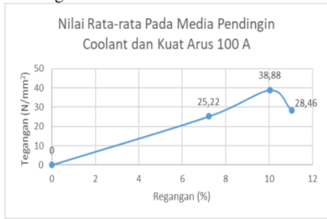
Gambar 18. Grafik Tegangan Pada Media Pendingin Coolant dan Kuat Arus 100 A
