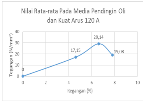
Gambar 17. Grafik Tegangan Pada Media Pendingin Oli dan Kuat Arus 120 A
