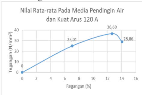
Gambar 14. Grafik Tegangan Pada Media Pendingin Air dan Kuat Arus 120 A
