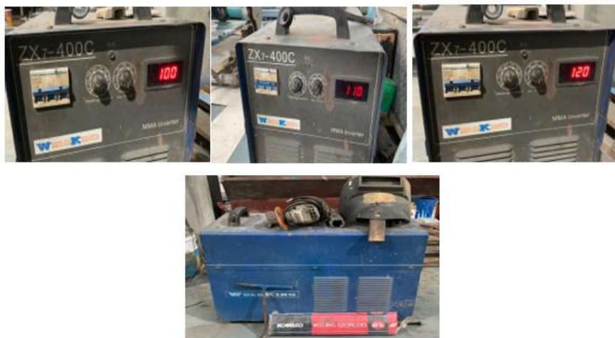
Dokumentasi Variasi Kuat Arus Pengelasan
