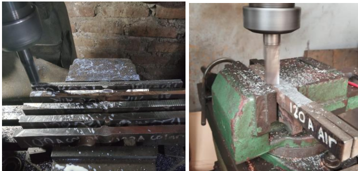
Dokumentasi proses milling pembuatan spesimen
