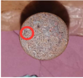
Gambar 19. Korosi Sumuran (Asam Fosfat 5 Hari)
