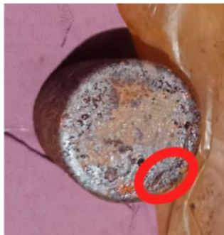
Gambar 20. Korosi Celah (Sodium Nitrit 15 Hari)
