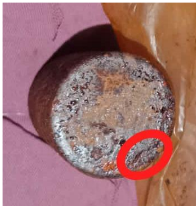
Gambar 20. Korosi Celah (Sodium Nitrit 15 Hari)
