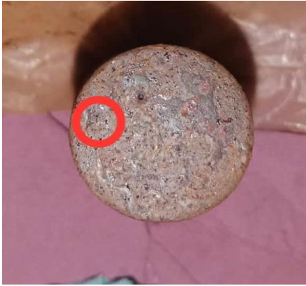
Gambar 19. Korosi Sumuran (Asam Fosfat 5 Hari)
