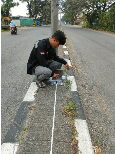
Pengukuran pembagian panjang segmen jalan per 100 meter
