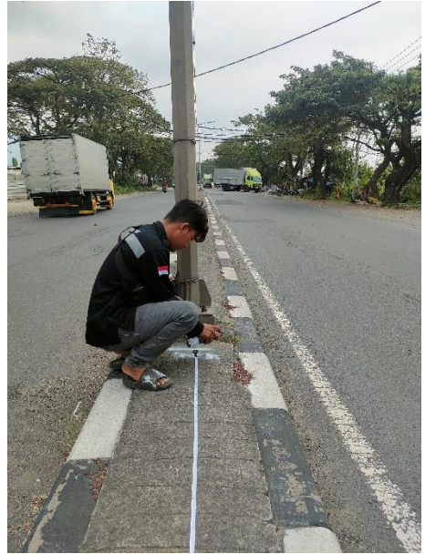
Pengukuran pembagian panjang segmen jalan per 100 meter
