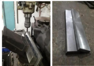
Gambar 3. Pembuatan kampuh las
