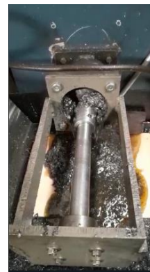
Gambar 35. Hasil Uji Kinerja Seperti terlihat didalam Gambar 35 scrap sisa permesinan dapat keluar dengan baik.
