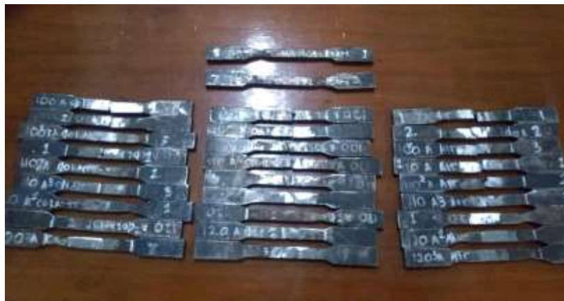
Spesimen Uji Tarik ASTM E8
