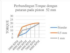
Data diatas menerangkan perbandingan Torrque hasil pengujian pada piston 52 mm dengan 3 variasi noken as. pada percobaan variable noken as std didapatkan Torque sebesar 2,05 pada putaran 3000 rpm dan mengalami kenaikan maksimal pada putaran 8000 rpm sebesar 19,35. Sedangkan Pada percobaan ke dua menggunakan
