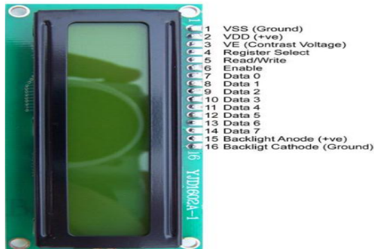
Gambar 2.6 Bentuk fisik dan konfigurasi LCD 2 x 16
