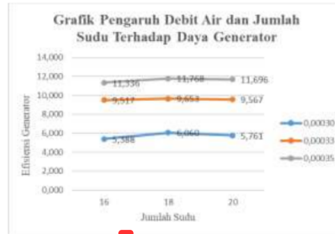
Gambar 6. Grafik pengaruh debit air dan jumlah sudu terhadap daya generator
