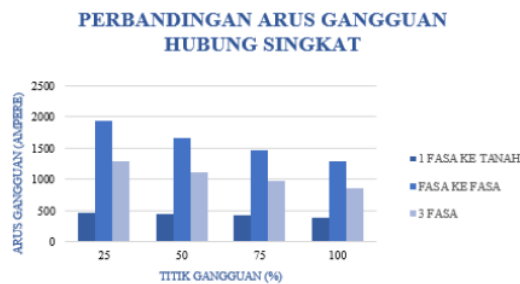
16 Gambar 2. Diagram Perbandingan Arus Gangguan Hubung Singkat
