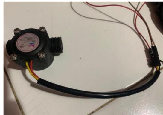
Gambar 15 Rangkaian Penyambung Kabel ke Sensor
