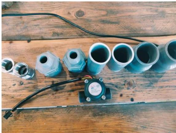
Gambar 13 Rangkaian Pipa Penghubung
