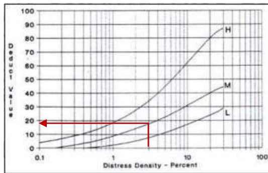
Gambar L.59.3 Retak Memanjang dan Retak Melintang
