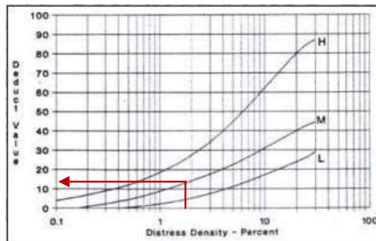
Gambar L.4.3 Retak Memanjang dan Retak Melintang
