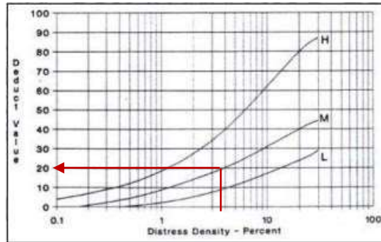
Gambar L.43.2 Retak Memanjang dan Retak Melintang
