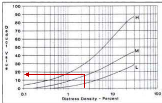
Gambar L.16.3 Retak Memanjang dan Retak Melintang
