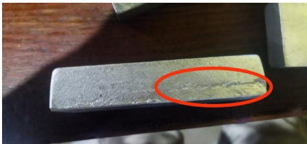
Gambar 20. Cacat Ekor Tikus Tak Menentu (700°C)
