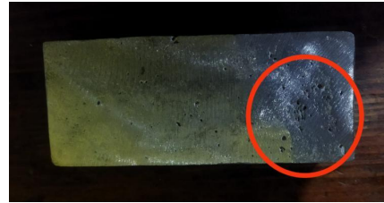
Gambar 23. Cacat Rongga Udara (750°C)
