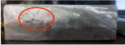
Gambar 19. Cacat Lubang Jarum (650°C)
