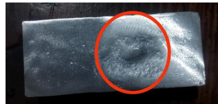
Gambar 24. Cacat Penyusutan Dalam (650°C)
