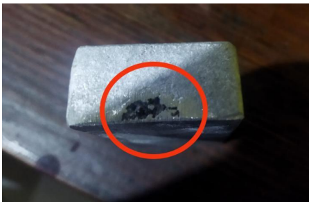
Gambar 21. Cacat Rongga Penyusutan (650°C, 700°C)
