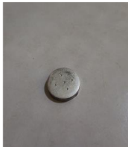
Gambar spesimen setelah uji kekerasan
