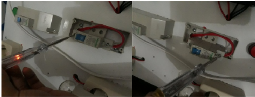
Gambar IV.16 Hasil Uji MCB Keadaan OFF
