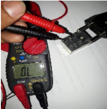
Gambar IV.12 Hasil Pengujian NO Relay Gambar IV.13 Hasil Pengujian NC Relay
