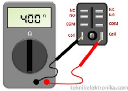
Gambar IV.7 Cara Menguji Coil Relay Sebelum Diaktifkan
