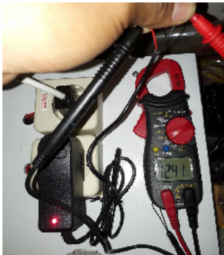
Gambar IV.14 Hasil Uji Adaptor dengan Multimeter
