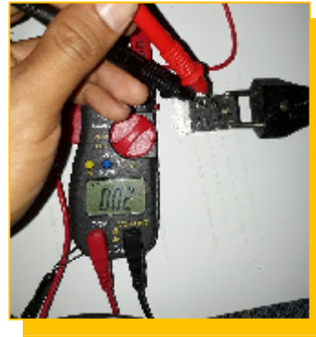
Gambar IV.12 Hasil Pengujian NO Relay Gambar IV.13 Hasil Pengujian NC Relay
