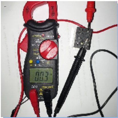
Gambar IV.9 Hasil Pengujian NC Relay
