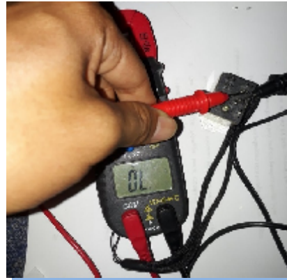
Gambar IV.8 Hasil Pengujian NO Relay
