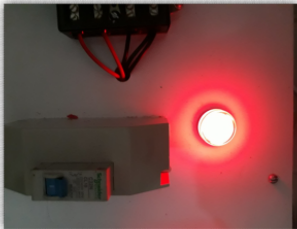
Gambar IV.5 Lampu Indikasi Merah Menyala Saat Diuji
