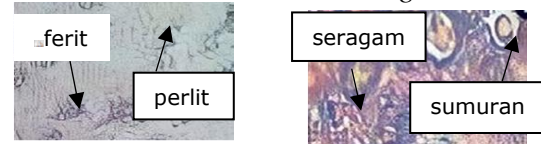
Gambar 9. Sebelum dan sesudah pengujian korosi
