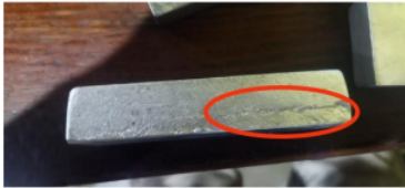
Gambar 20. Cacat Ekor Tikus Tak Menentu (700°C)
