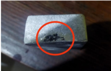
Gambar 21. Cacat Rongga Penyusutan (650°C, 700°C)
