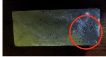
Gambar 23. Cacat Rongga Udara (750°C)
