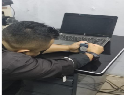
Gambar 6 Pengujian kekerasan type shore D
