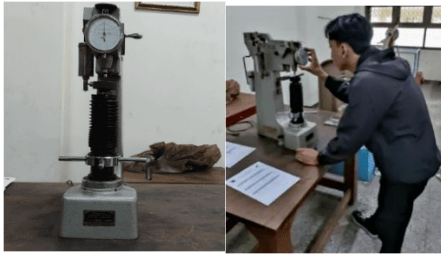
Gambar 8. Proses uji kekerasan dengan metode rockwell
