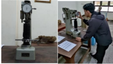
Gambar 8. Proses uji kekerasan dengan metode rockwell
