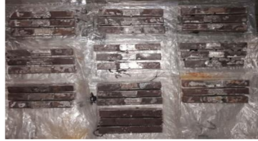
Gambar 7. Pembuatan spesimen uji impact (JIZ2202)
