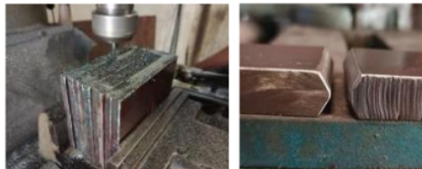
Gambar 3. Proses frais untuk pembuatan alur double v - groove
