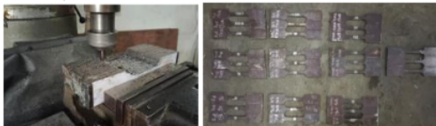
Gambar 6. Pembuatan spesimen uji tarik (JIZ2201)
