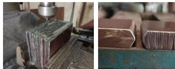
Gambar 3. Proses frais untuk pembuatan alur double v – groove
