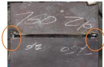
Gambar 5 Pembuatan Track Weld
