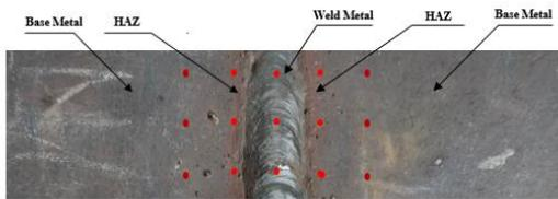
Gambar 9. Titik pengambilan data pada uji kekerasan
