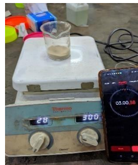
Gambar 3. Pencampuran bahan dan diaduk menggunakan mixer
