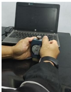
Gambar 7. Proses uji kekerasan Shore D
