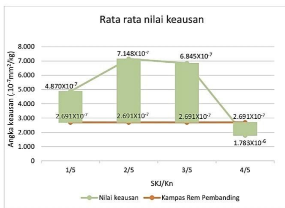
Gambar 14. Grafik Hasil Pengujian Keausan Serbuk Kayu Jati (SKJ)/Kuningan
