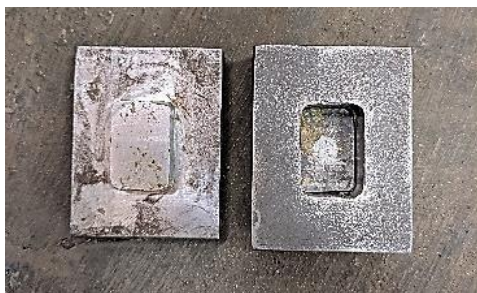
Gambar 1. Desain dan Cetakan Kampas Rem
