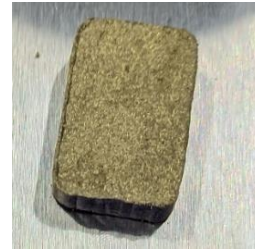
Gambar 5. Spesimen Kampas Rem
