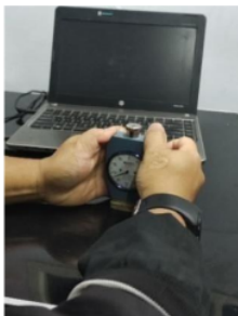
Gambar 7. Proses uji kekerasan Shore D
