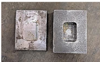
Gambar 1. Desain dan Cetakan Kampas Rem
