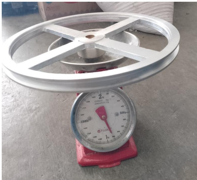
Lampiran 8 : Berat Pulley diameter 30 cm (0,9 kg)
