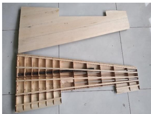
Pemasangan lembar balsa pada sayap utama
