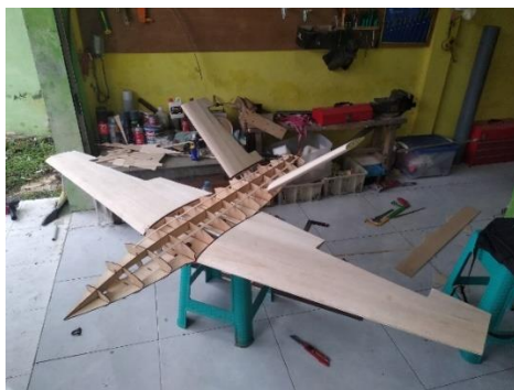
Pemasangan sayap dan ekor ke bodi drone
