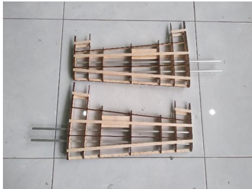
Rangka ekor drone ( V-Tail )
