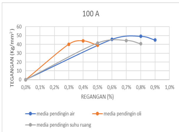
Gambar 7. Grafik tegangan dan regangan dengan arus pengelasan 100 A
