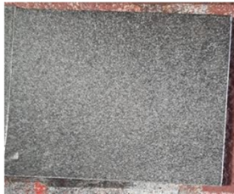
Gambar 7. Hasil proses sandblasting dengan tekanan 5 bar dan waktu 8 detik.
