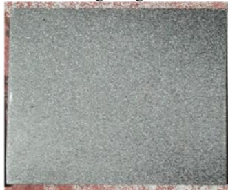
Gambar 8. Hasil proses sandblasting dengan tekanan 5 bar dan waktu 12 detik.
