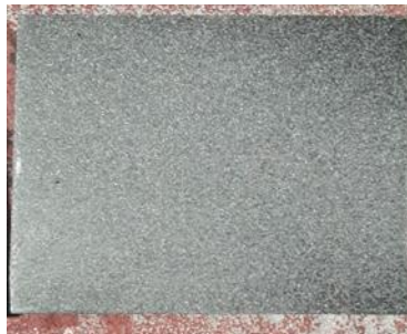
Gambar 5. Hasil proses sandblasting dengan tekanan 4 bar dan waktu 12 detik.
