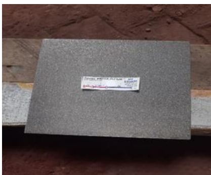
Gambar 11. Hasil proses sandblasting dengan tekanan 6 bar dan waktu 12 detik.
