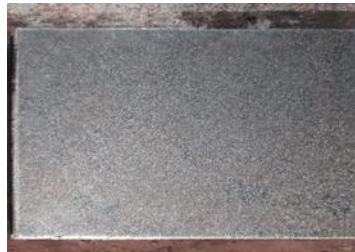
Gambar 4. Hasil proses sandblasting dengan tekanan 4 bar dan waktu 8 detik.
