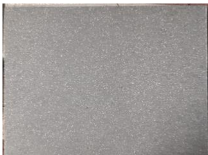
Gambar 10. Hasil proses sandblasting dengan tekanan 6 bar dan waktu 8 detik
