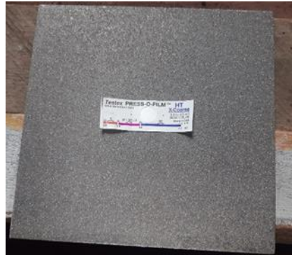
Gambar 12. Hasil proses sandblasting dengan tekanan 6 bar dan waktu 16 detik.
