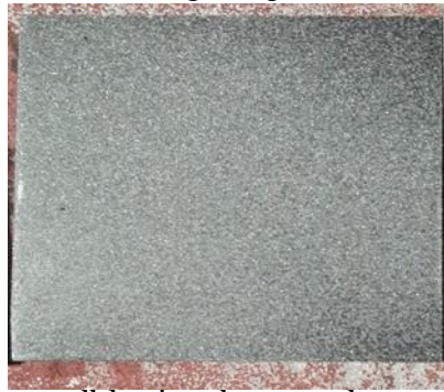
Gambar 8. Hasil proses sandblasting dengan tekanan 5 bar dan waktu 12 detik.
