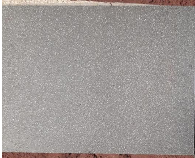
Plat yang sudah dilakukan penyemprotan proses sandblasting ( sumber: foto sendiri )
