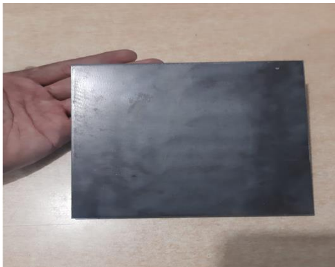
Spesimen uji plat stainless stell 37 sebelum penyemprotan sandblasting ( sumber: foto pribadi )
