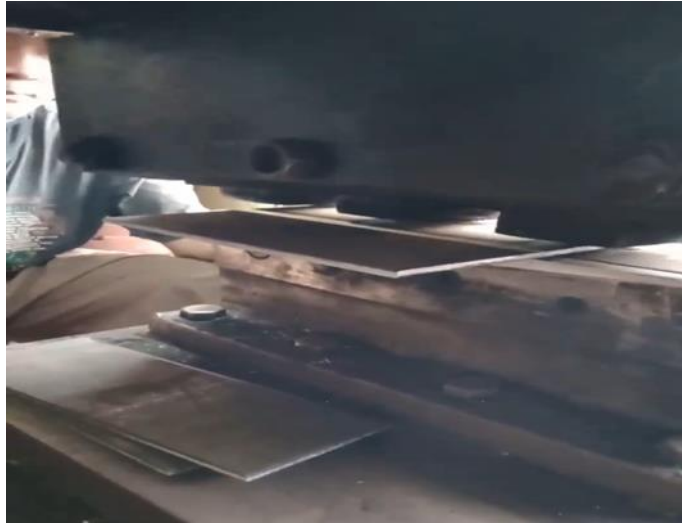
Proses pemotongan spesimen uji 15 cm x 15 cm tebal 4 mm ( sumber : foto sendiri )
