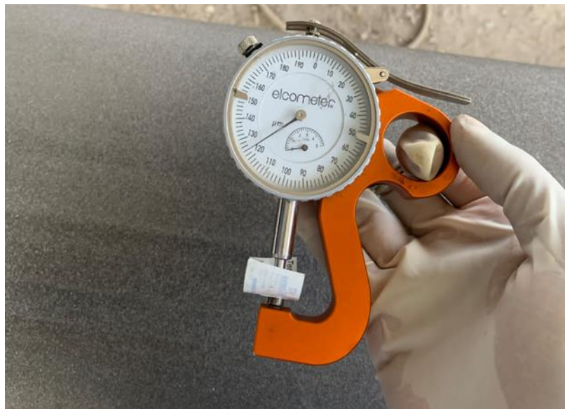
Pengujian kekasaran menggunakan alat elcometer 122 testex® tape ( sumber : foto sendiri )
