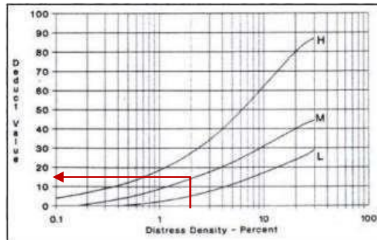
Gambar L.44.2 Retak Memanjang dan Retak Melintang
