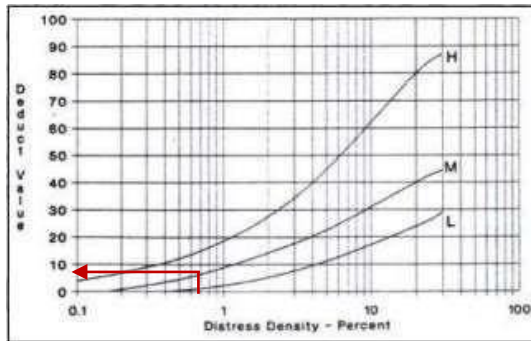
Gambar L.56.2 Retak Memanjang dan Retak Melintang
