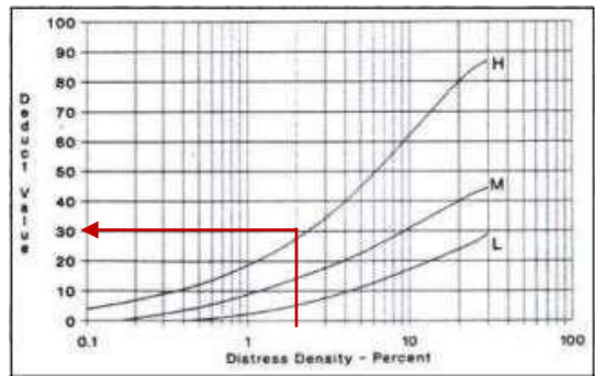
Gambar L.52.3 Retak Memanjang dan Retak Melintang
