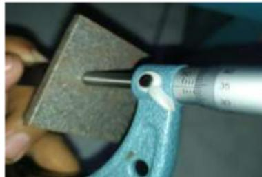
Gambar 10. Pengujian ketebalan
