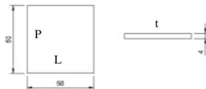
Gambar 2. Dimensi spesimen uji
