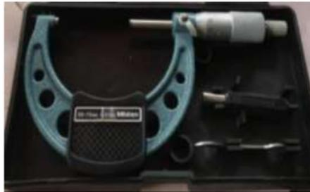
Gambar 6. Mikrometer
