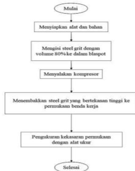
Gambar 4. Diagram alir proses sandblasting
