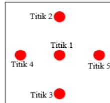
Gambar 7. Titik uji kekerasan rockwell
