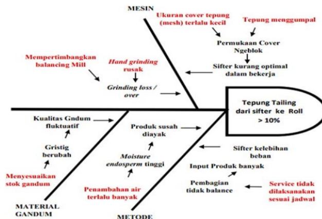
1 Gambar 3. Analisis Permasalahan Dengan Menggunakan Diagram Fishbone Faktor-faktor yang mempengaruhi kinerja sifter antara lain sebagai berikut :
