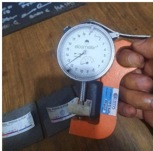
Pengukuran nilai kekasaran pada sudut 45 derajat jarak 40 cm
