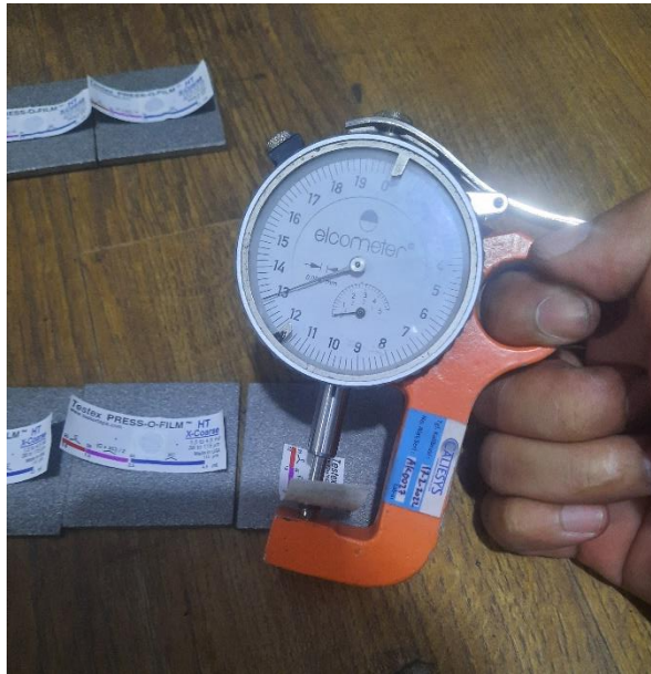
Pengukuran nilai kekasaran pada sudut 60 derajat jarak 60 cm
