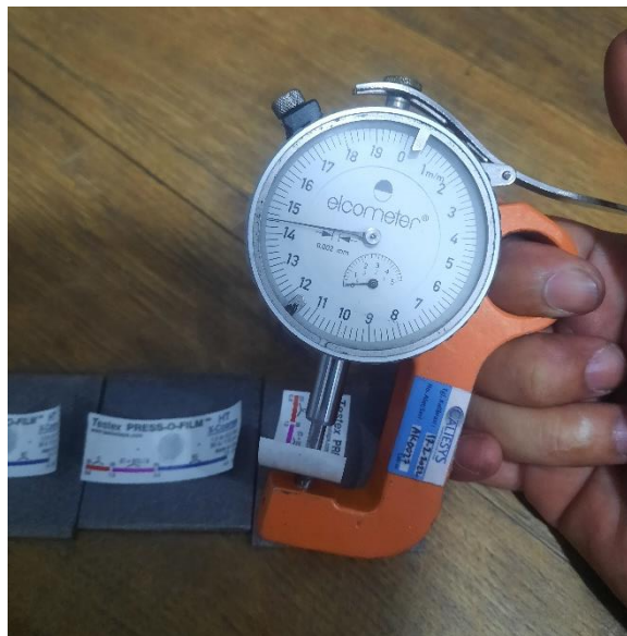
Pengukuran nilai kekasaran pada sudut 90 derajat jarak 40 cm
