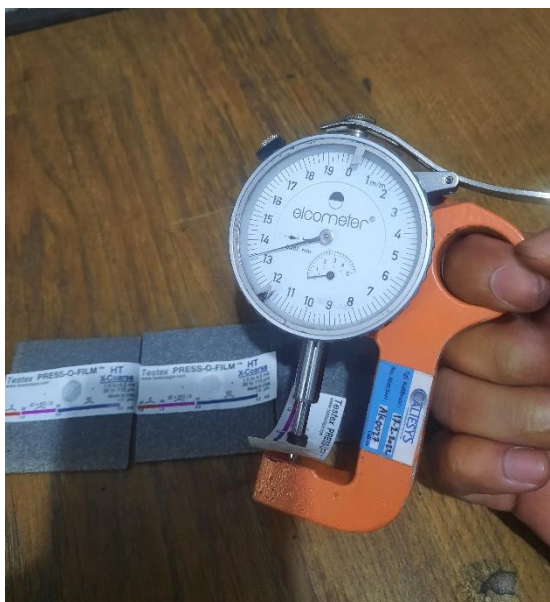
Pengukuran nilai kekasaran pada sudut 90 derajat jarak 60 cm
