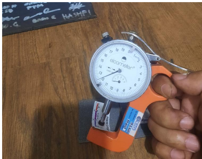
Pengukuran nilai kekasaran pada sudut 45 derajat jarak 60 cm
