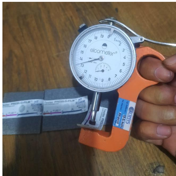
Pengukuran nilai kekasaran pada sudut 60 derajat jarak 50 cm
