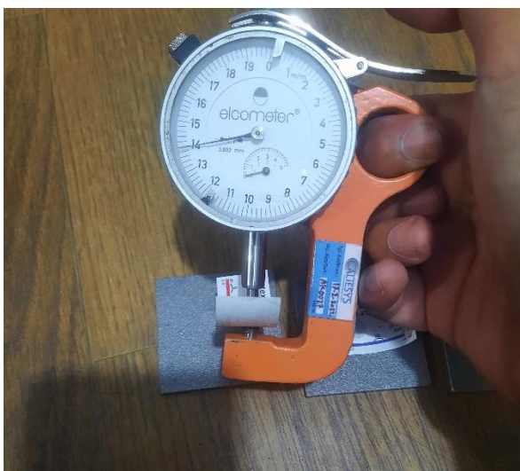
Pengukuran nilai kekasaran pada sudut 90 derajat jarak 50 cm
