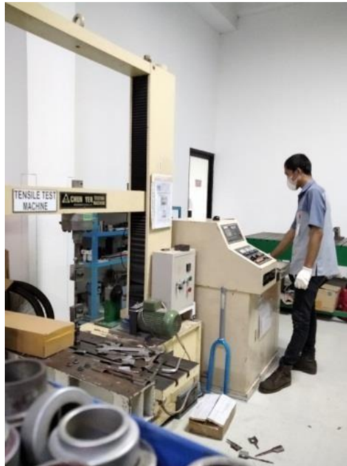
Gambar 3.16 Proses Uji Tarik
