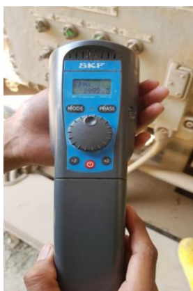
Gambar 5. Hasil Pengukuran Putaran Motor Copressor
