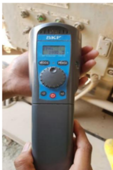
Gambar 5. Hasil Pengukuran Putaran Motor Compressor
