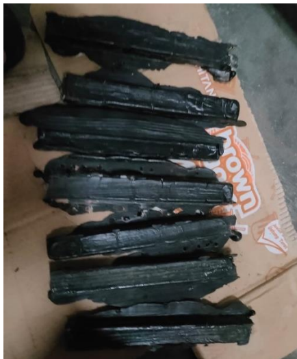
Cetakan dan hasil cetakan sebelum dan sesudah dirapihkan
